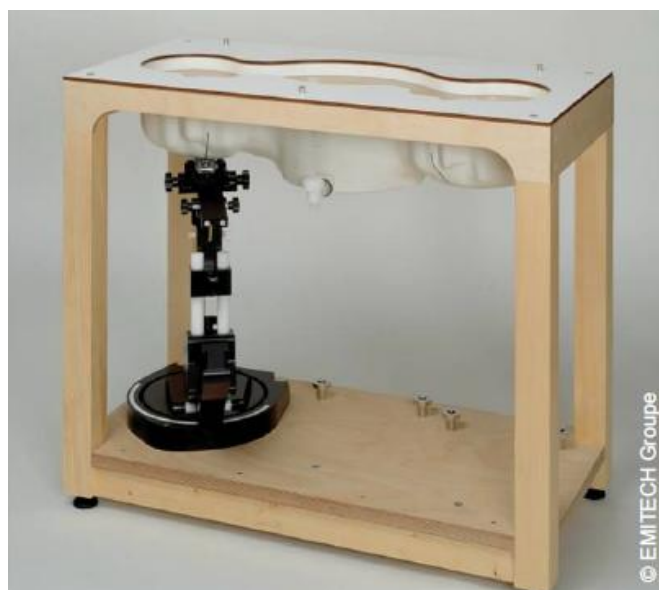
Figure 73 : exemple de téléphone placé contre le mannequin représentant la tête remplie de liquide
