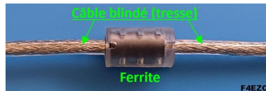
Figure 45 : exemple de câble transparent permettant de vérifier la présence de blindage
