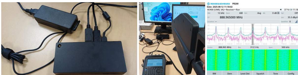
Figure 49 : brouillage UHF par une station d'accueil informatique avec câbles HDMI
