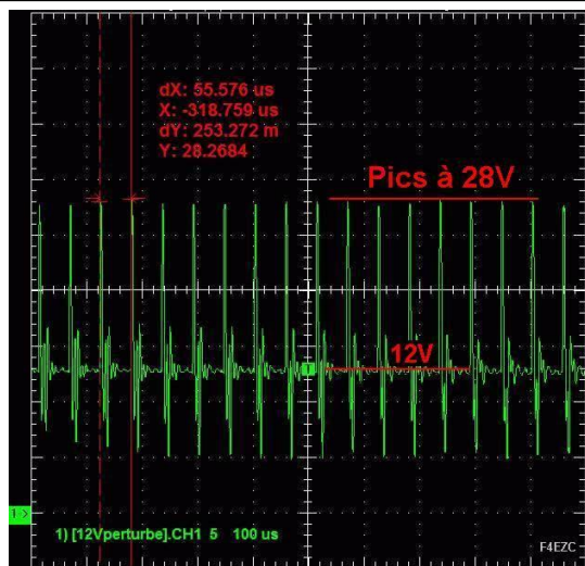
Figure 43 : exemple de variations de tension d'un onduleur défectueux
