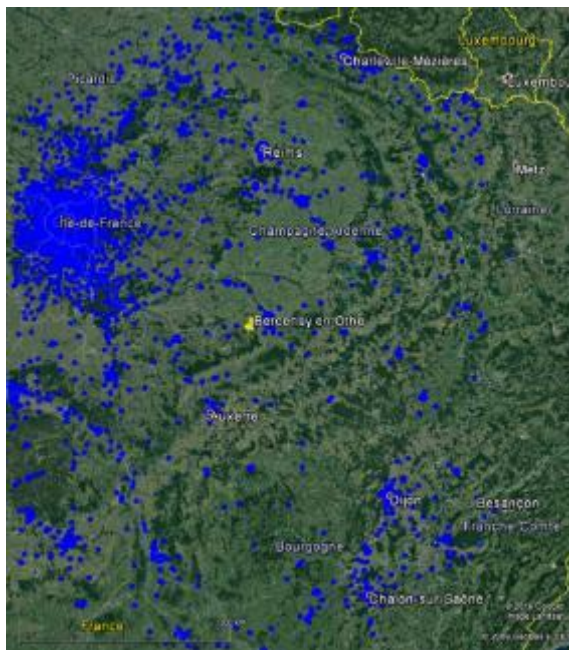
Figure 20 Exemple des résultats d'agrégation pour Bercenay Ouest, p.i.r.e. max = 74 dBm/20 MHz
