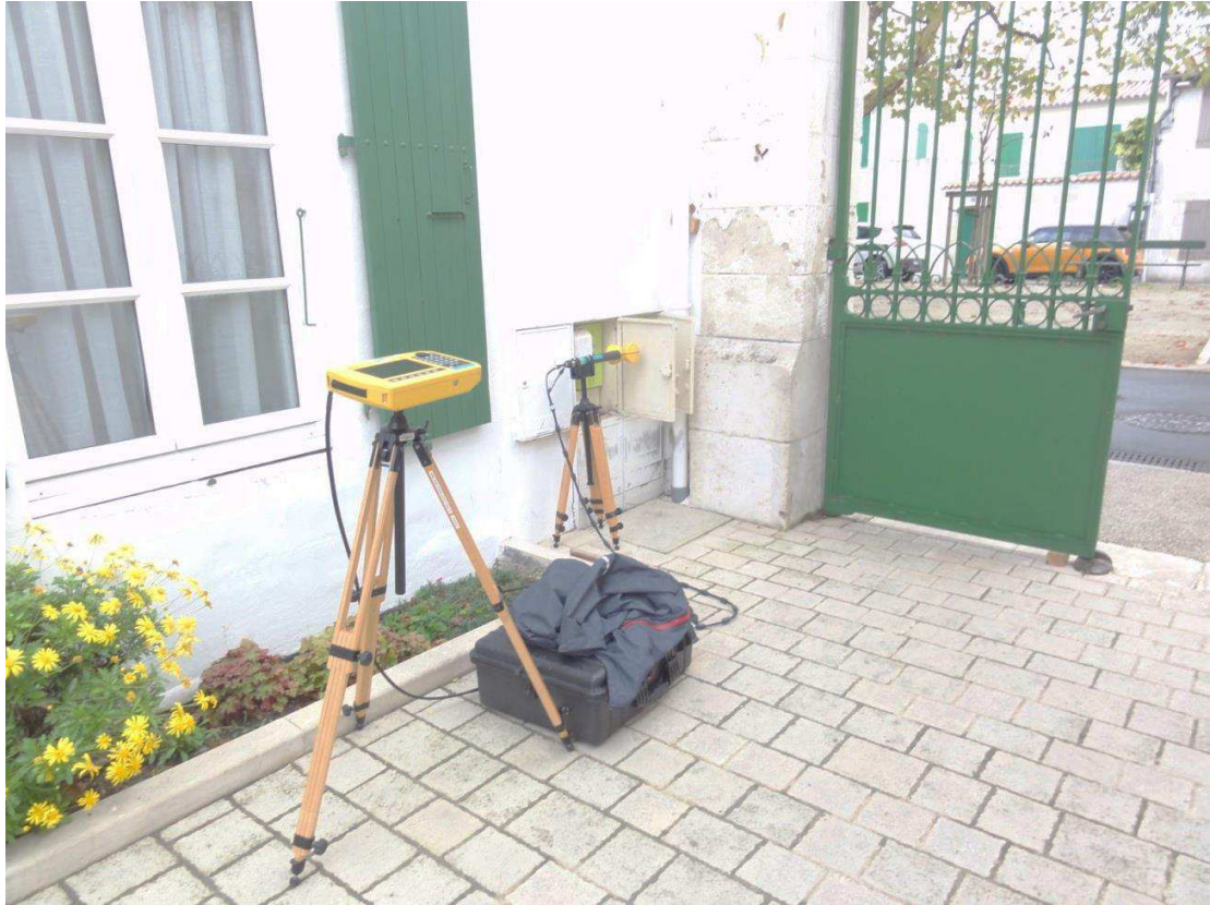
Mesure avec l'antenne électrique devant le compteur
