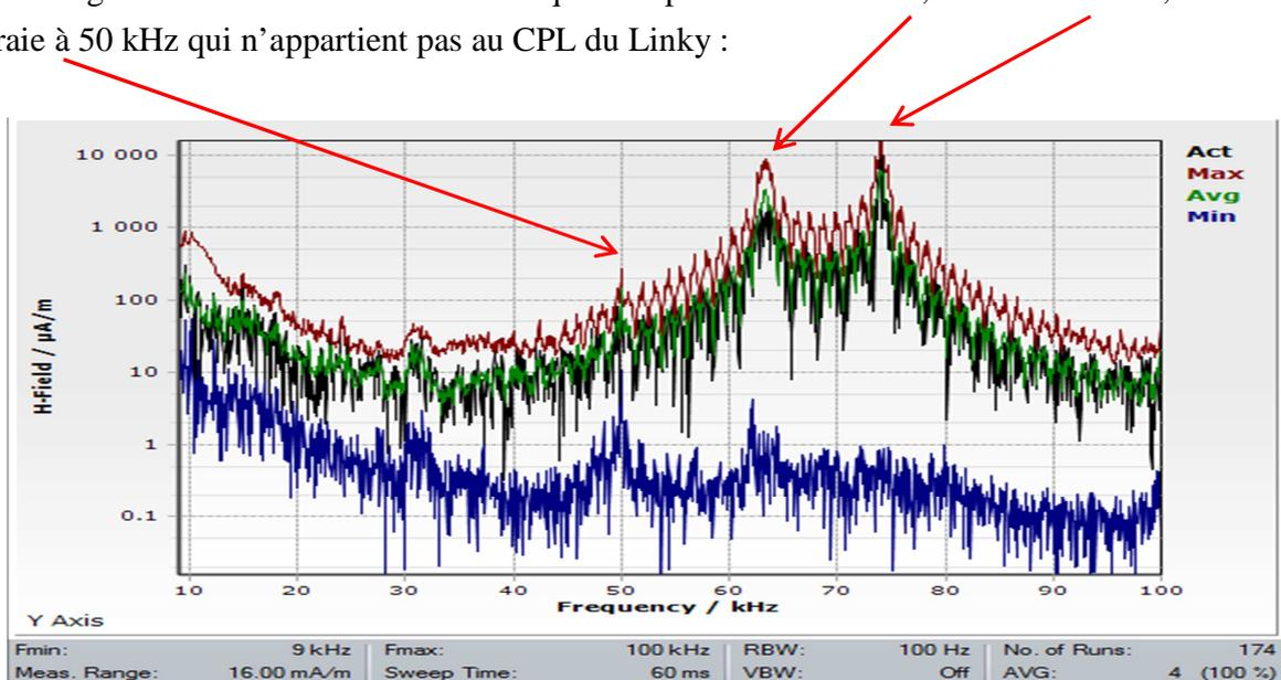
L'analyse spectrale du champ magnétique à 20 cm du compteur
