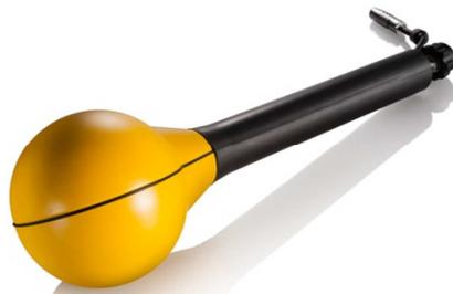
ANTENNE TRIAXIALE MAGNÉTIQUE 9 kHz - 250 MHz NARDA type 3581/02
