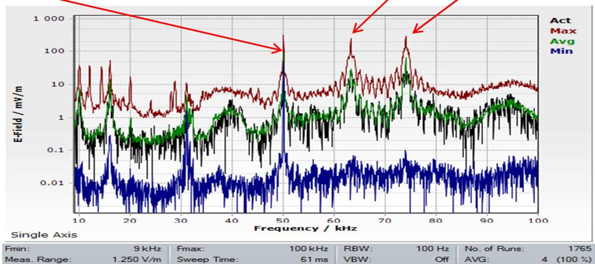
L'analyse spectrale du champ électrique à 20 cm du compteur
