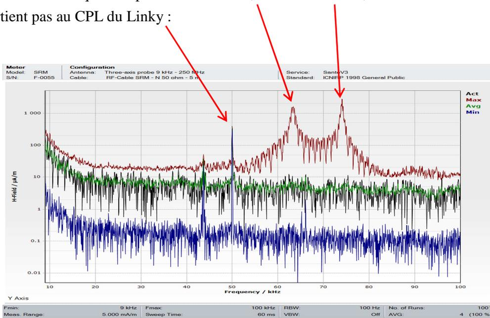
L'analyse spectrale du champ magnétique à 20 cm du compteur
