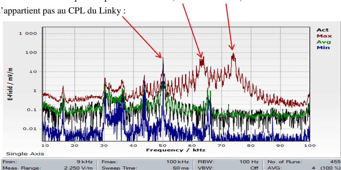
L'analyse spectrale du champ électrique à 20 cm du compteur
