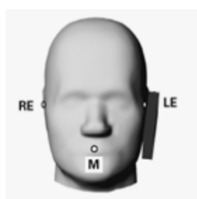
Figure 2: illustration des deux positions d'essai normalisées pour tester les équipements utilisés contre l'oreille
