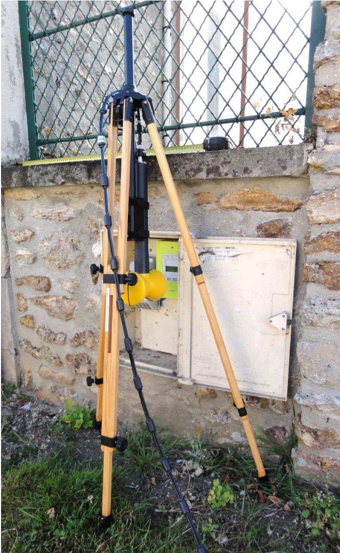
Mesure avec l'antenne électrique puis magnétique devant le compteur
