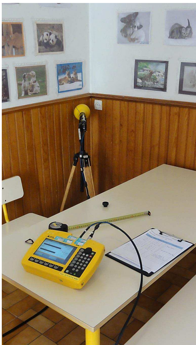
Mesure avec l'antenne magnétique puis l'antenne électrique devant la prise
