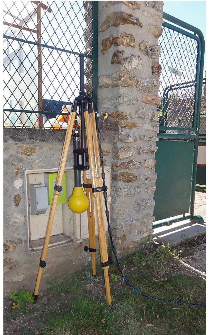
Mesure avec l'antenne électrique puis magnétique devant le compteur
