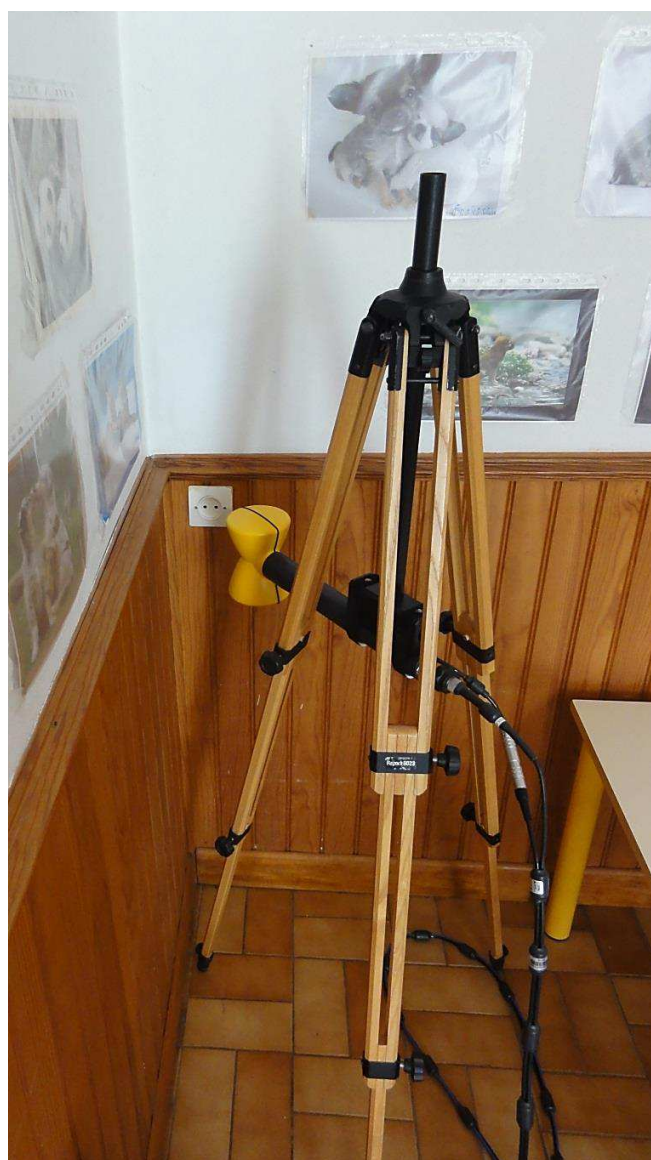
Mesure avec l'antenne magnétique puis l'antenne électrique devant la prise
