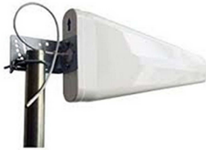
Figure 10 : illustration d'une antenne log périodique
