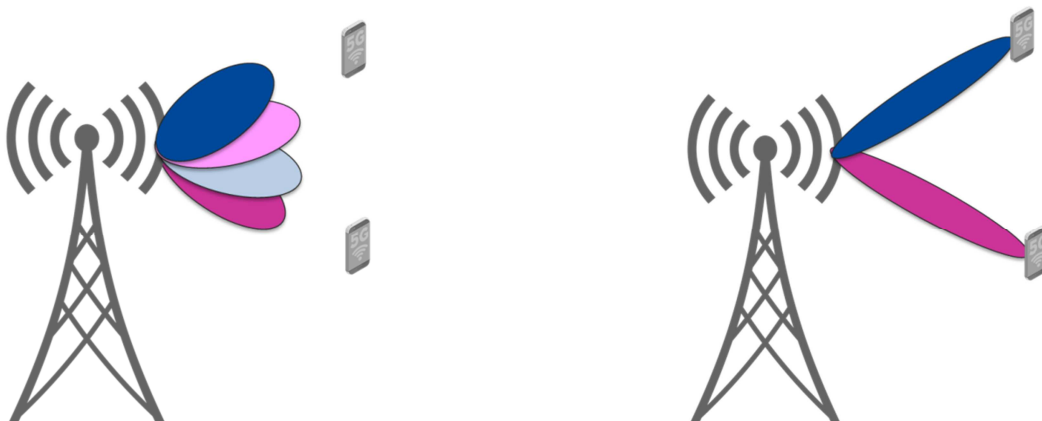
Figure 15 : illustration, à gauche, de la phase de beam sweeping/scanning pour identifier les utilisateurs et à droite des faisceaux de trafic servant à la demande les utilisateurs.
