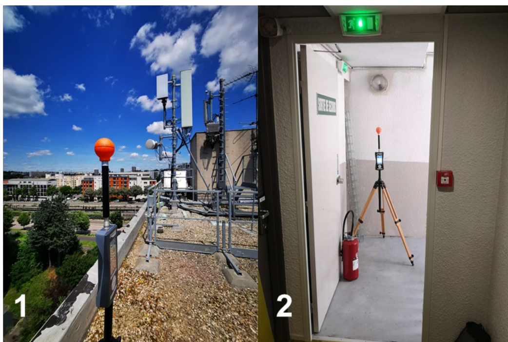
Figure 20 Positions de mesure avec la sonde large bande (cas A – 20 MHz à 40 GHz) sur le toit (n°1) et dernier étage sous l'antenne FH (n°2)
