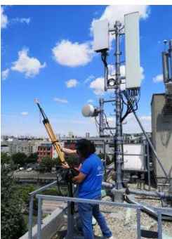
Figure 21 Description de la variation de l'analyse spectrale en fonction de la distance par rapport à l'antenne FH et dans son faisceau
