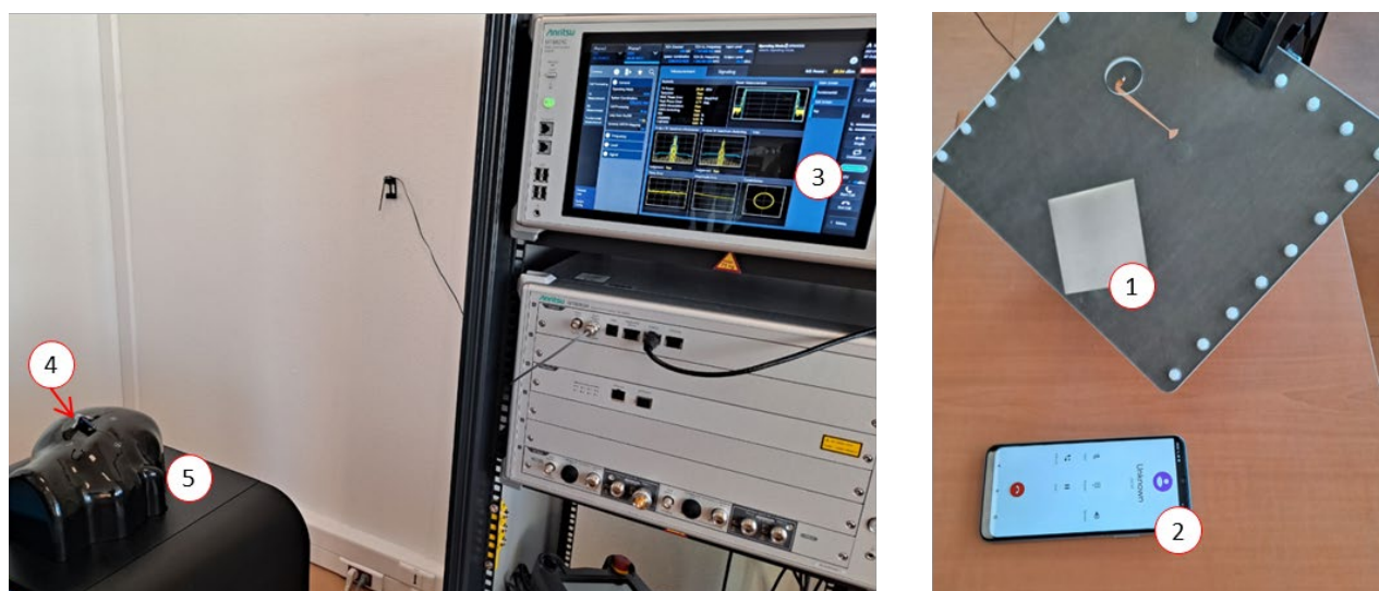
Figure 3: illustration d'un mode opératoire d'une mesure de DAS sur kit sans fil. (1) Antenne de liaison, (2) téléphone, (3) kit oreillette sans-fil, (4) fantôme du banc de mesure DAS.
