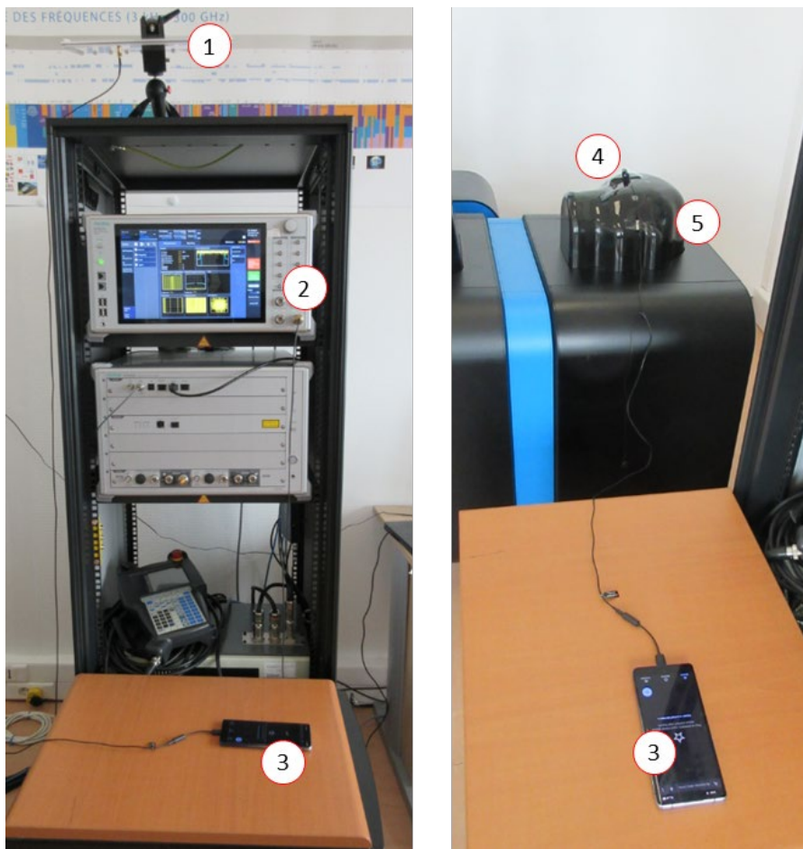
Figure 2: illustration d'un mode opératoire d'une mesure de DAS sur kit filaire. (1) antenne de liaison, (2) station de base, (3) téléphone, (4) kit oreillette filaire, (5) fantôme du banc de mesure DAS.
