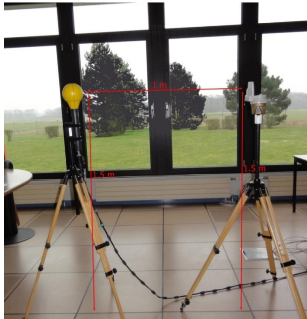
Figure 7 : disposition de l'antenne de mesure et du module sur le compteur d'eau
