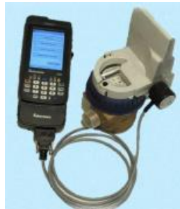
Figure 5 : PDA de maintenance qui permet de déclencher la transmission des trames
