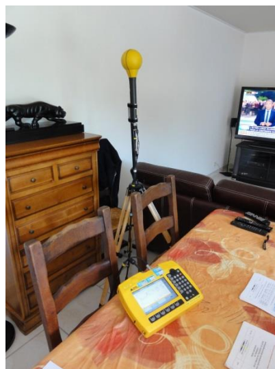
Figure 26 : emplacement du lieu de la mesure de champ électromagnétique in situ COFRAC
