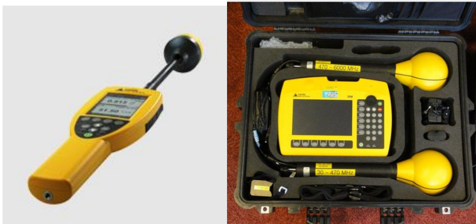
Figure 6 : matériel de mesure des champs électriques, large bande à gauche et sélectif en fréquence à droite
