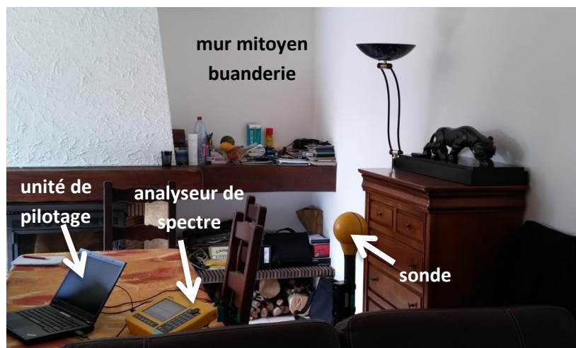
Figure 22 : installation de la chaîne de mesure dans un lieu où les personnes séjournent durablement
