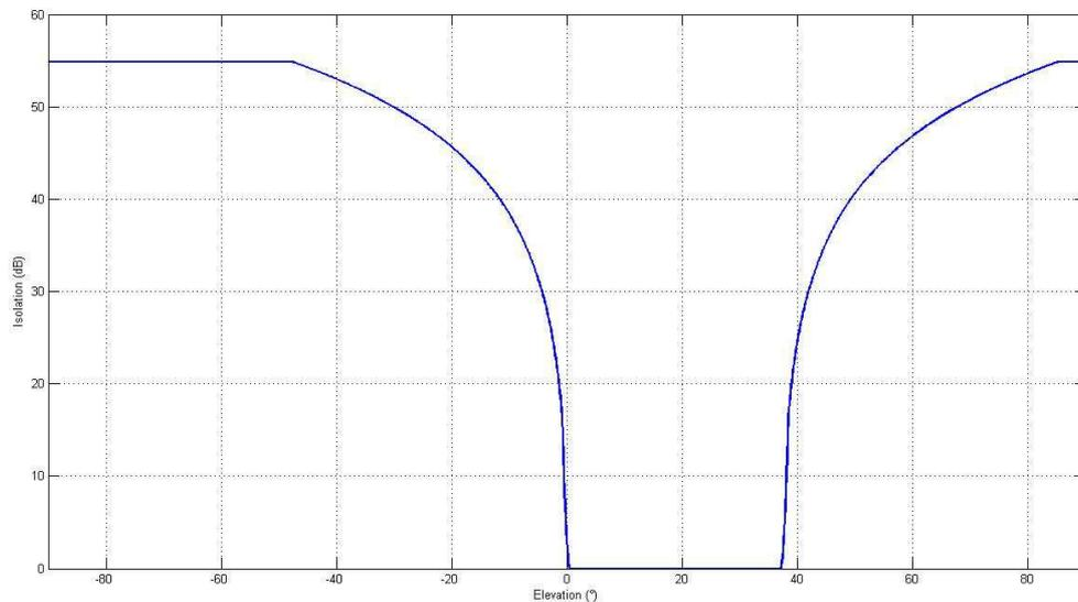
En pratique, les angles d'élévation dans la direction d'une station de base seront plutôt faibles (de l'ordre de -10°/+10° maximum). Toutefois plusieurs de ces radars sont localisés sur des hauteurs, et la prise en compte de la discrimination antennaire permet dans ce cas de réduire considérablement les contraintes.
