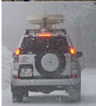
Figure n°33 : Exemples d'équipements utilisés par l'ANFR pour le traitement des brouillages – Source : ANFR
