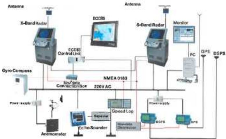
Figure n°5 - Architecture présentant l'utilisation du GNSS sur une passerelle de navire.
