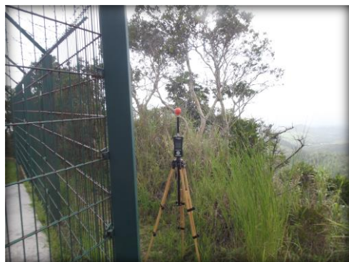
Mesure de l'exposition aux champs électromagnétiques sur le chemin de randonnée jouxtant le site radio du Mont Koghi
