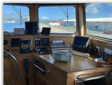
Contrôle de la VHF ASN à l'aide d'une Test Box Néotek à bord de l'Amborella
