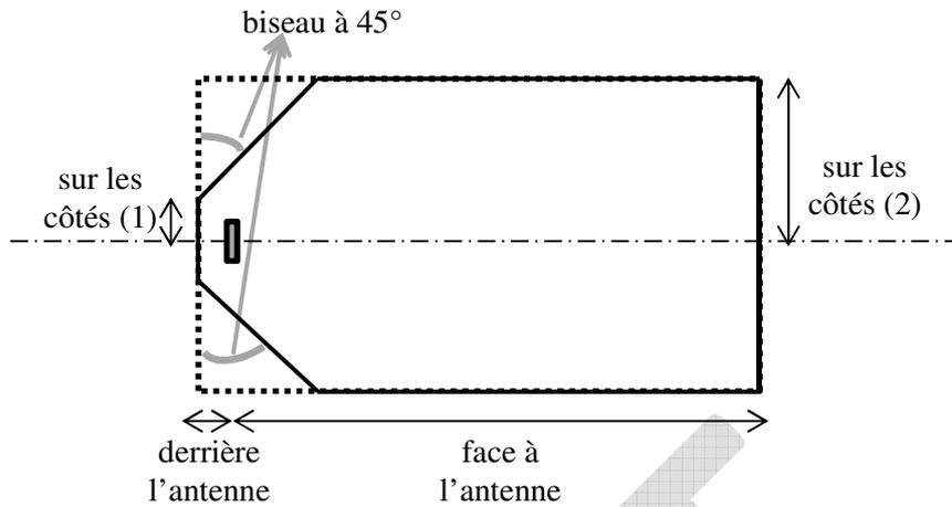
**Figure 4 : Exemple de forme du périmètre de sécurité pour les antennes macro-cellules**
