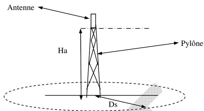
Figure 14 : antenne de radiodiffusion FM sur pylône
