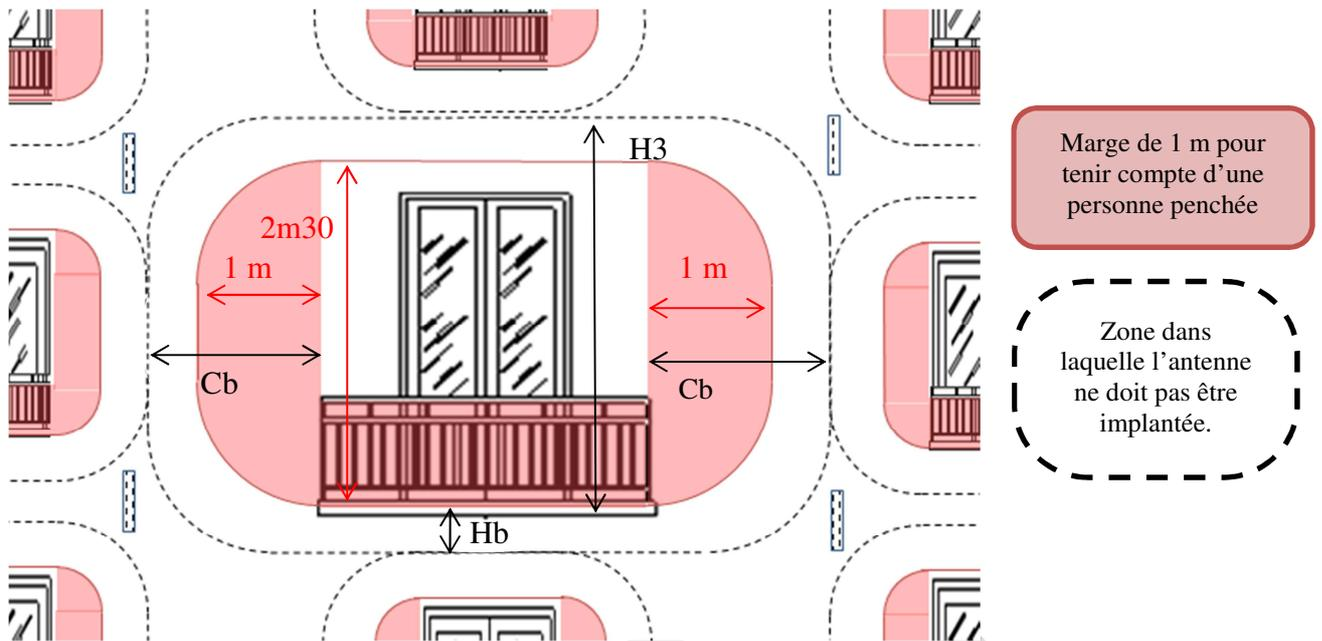
Figure 7 : Règles d'installation à proximité d'un balcon
