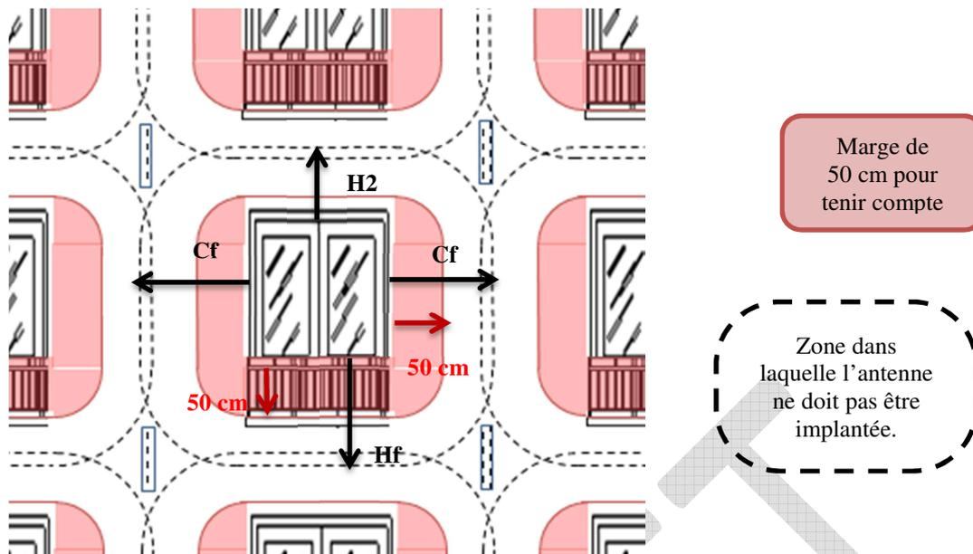
Figure 6 : Règles d'installation à proximité d'une fenêtre
