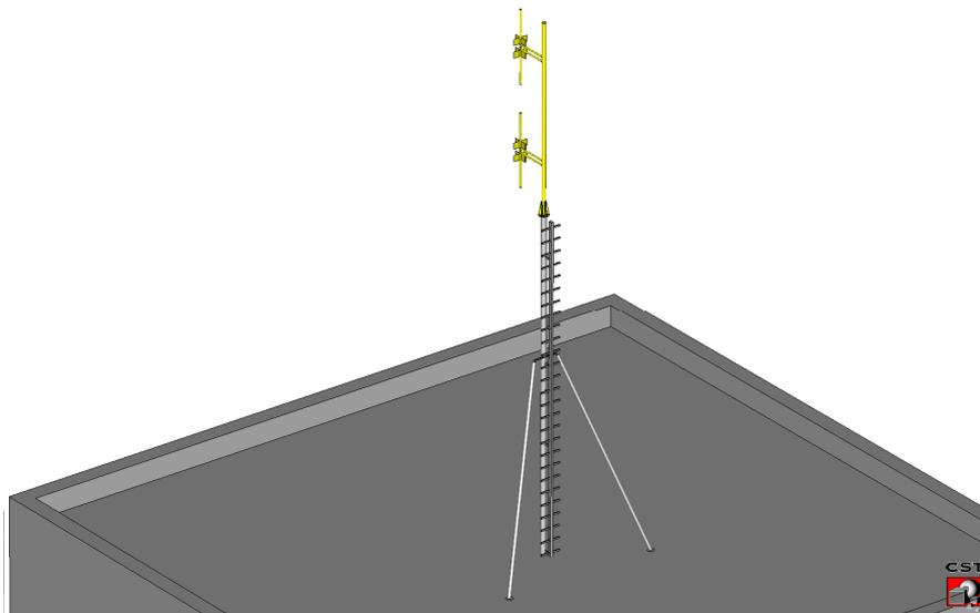
Figure 13 : antenne de radiodiffusion FM sur terrasse
