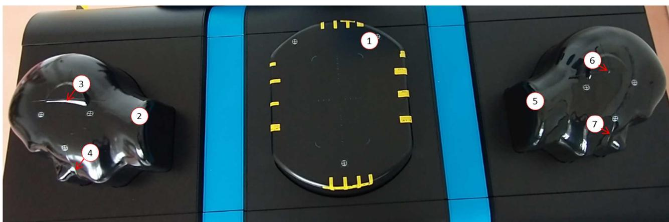
**Figure 4: illustration des 3 fantômes du banc de mesure DAS. (1) Fantôme plan, (2) fantôme tête gauche, (3) point de référence oreille gauche, (4) ligne de référence oreille-bouche gauche, (5) fantôme tête droite, (6) point de référence oreille droite (7) ligne**
