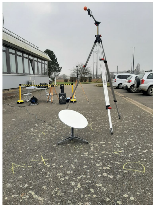
Figure 6 Photographie de la sonde large bande positionnée 2 m au-dessus de l'antenne Starlink (point S200)
