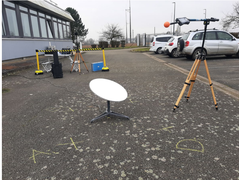
Figure 7 Photographie de la sonde large bande à la position du niveau maximal relevé D 100
