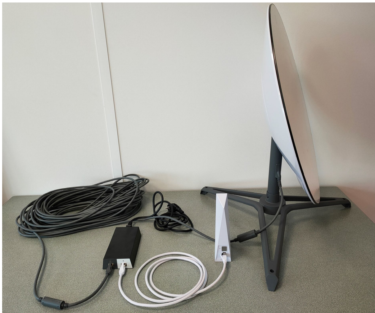
Figure 1 Photographie du kit fourni aux particuliers pour se connecter au réseau Starlink
