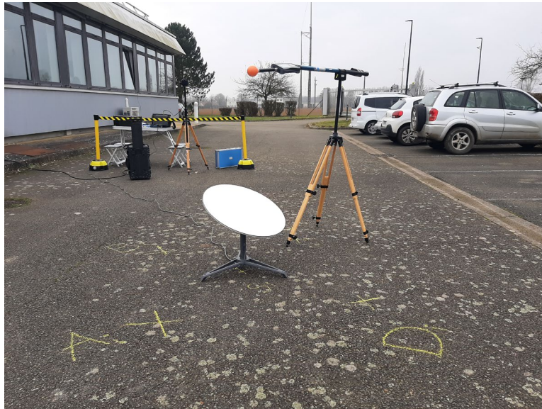
Figure 5 Photographie de la sonde large bande positionnée 1 m au-dessus de l'antenne Starlink (point S100)
