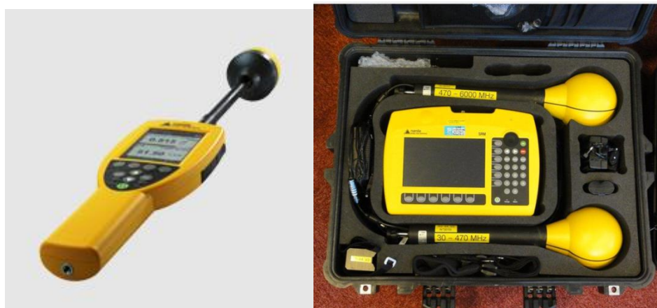
Figure 7 : matériel de mesure des champs électriques large bande à gauche et sélectif en fréquence à droite
