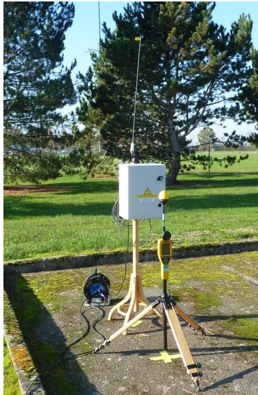
Figure 22 : configuration d'une mesure large bande pour le cas A sur le concentrateur SagemCom
