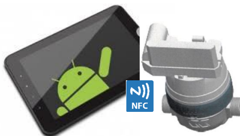
Figure 4 : tablette de maintenance qui permet de déclencher la transmission des trames par NFC
