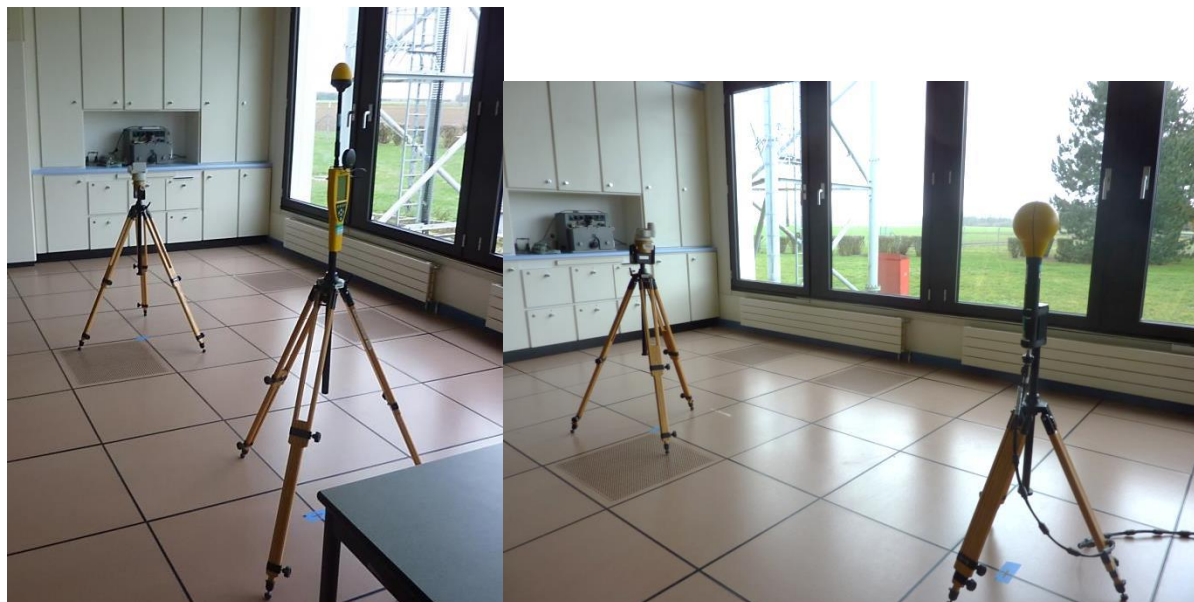
Figure 16 : configuration de la mesure COFRAC sur le compteur Itron 1 à gauche et Diehl 2 à droite
