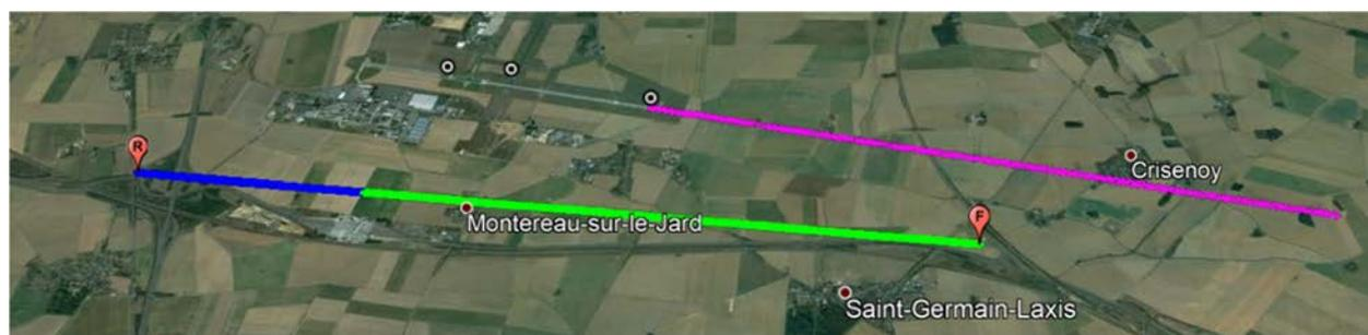
**Brouillage du FH de Cabannes 2 par l'EFVS pour une approche en piste (28) à l'aéroport d'Avignon Caumont 1. Les lignes verte et bleue indiquent respectivement la direction d'émission du FH émetteur et de réception du FH récepteur.**
