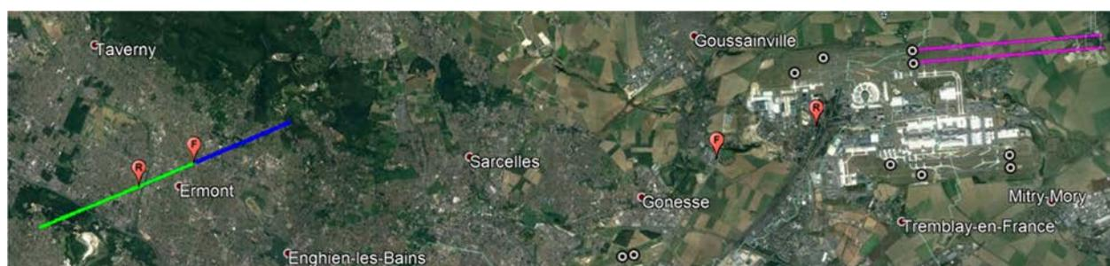
**Brouillage du FH d'Ermont Calmette par l'EFVS pour une approche respectivement en pistes (27 R) et (27 L) aux aéroports de Paris Charles de Gaulle 3 et 4. Les lignes verte et bleue indiquent respectivement la direction d'émission du FH émetteur et de réception du FH récepteur.**
