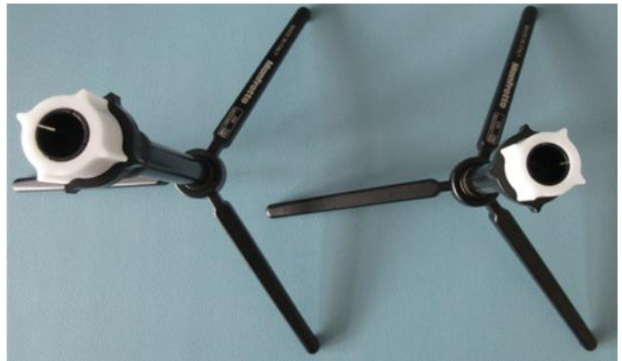
Figure 5: Vues de face et de haut des trépieds pour le positionnement des dipôles Speag
