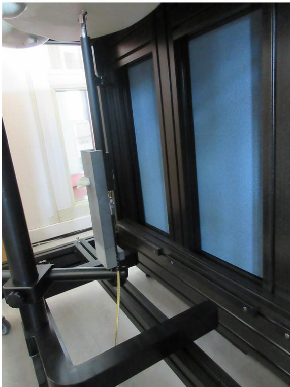
Figure 8: exemples de positionnement des dipôles lors de la vérification intermédiaire
