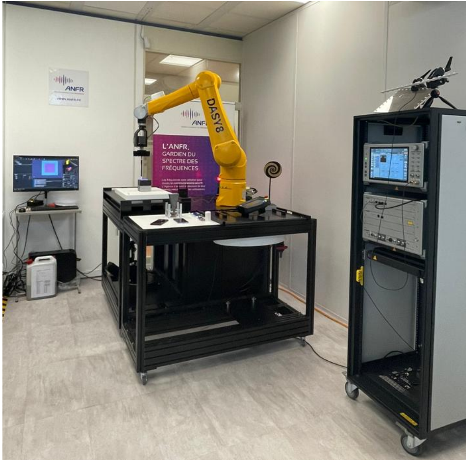
Figure 2: zone de placement du banc de mesure DASY8
