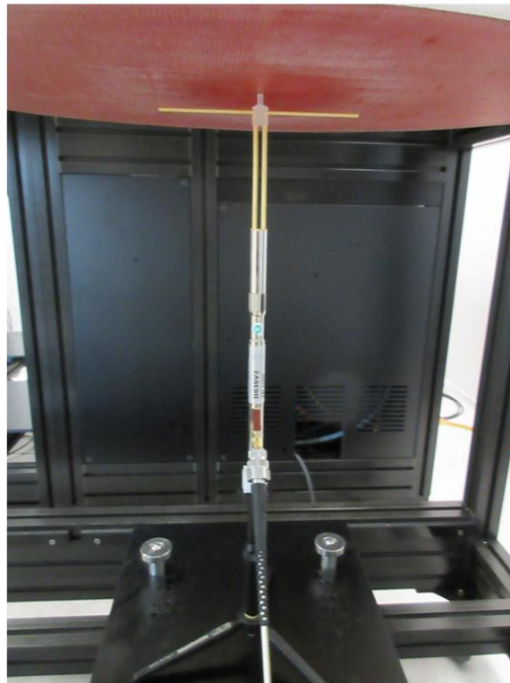
Figure 8: exemples de positionnement des dipôles lors de la vérification intermédiaire
