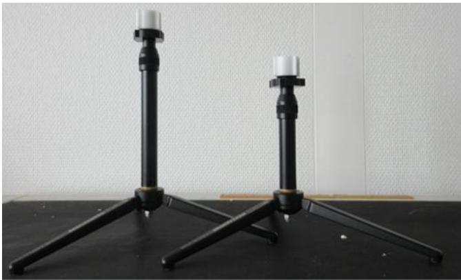
Figure 5: Vues de face et de haut des trépieds pour le positionnement des dipôles Speag
