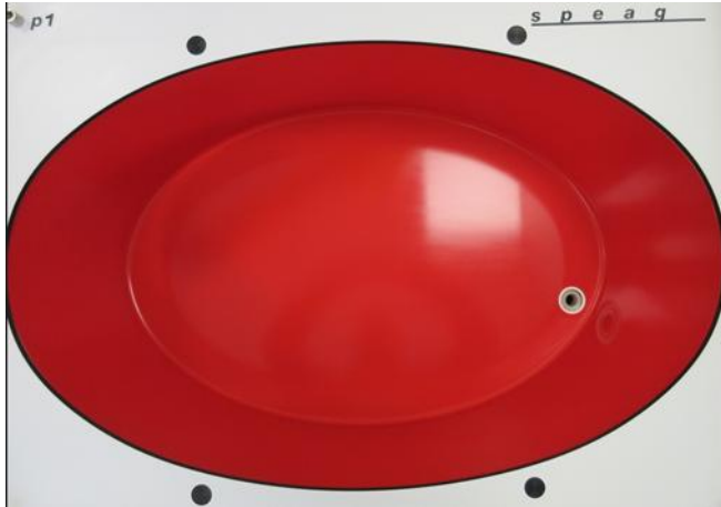
Figure 3: photo de la cuve Eli
