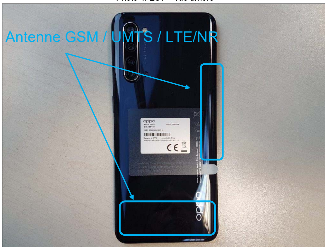
Photo 4: EST – vue arrière
