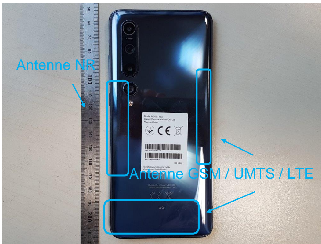
Photo 4: EST – vue arrière
