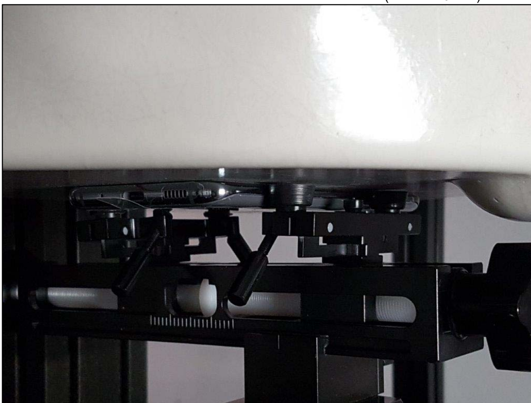
Photo 8: Position d'essai face arrière contre le membre (distance 0 mm)
