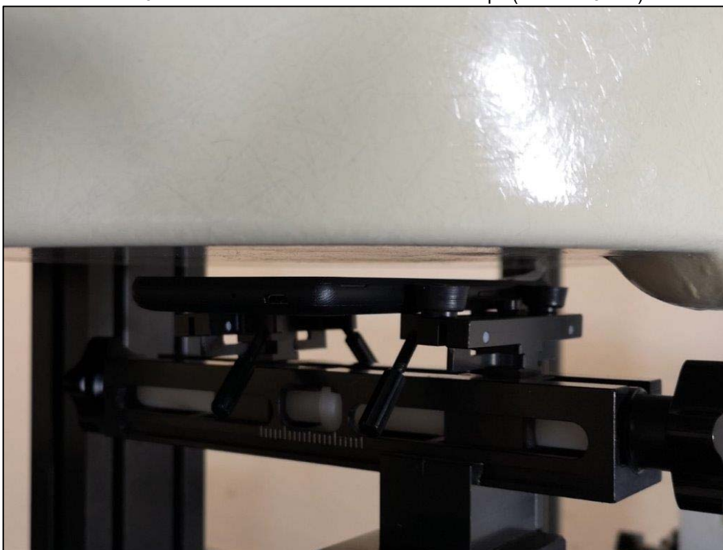
Photo 10: Position d'essai face arrière contre le corps (distance 5 mm)
