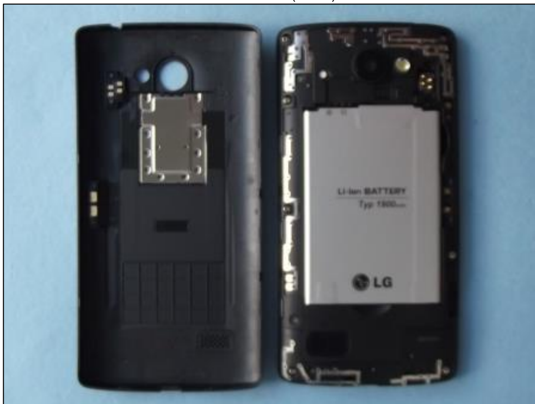
Photo 5: EST – vue arrière (ouvert) avec batterie
