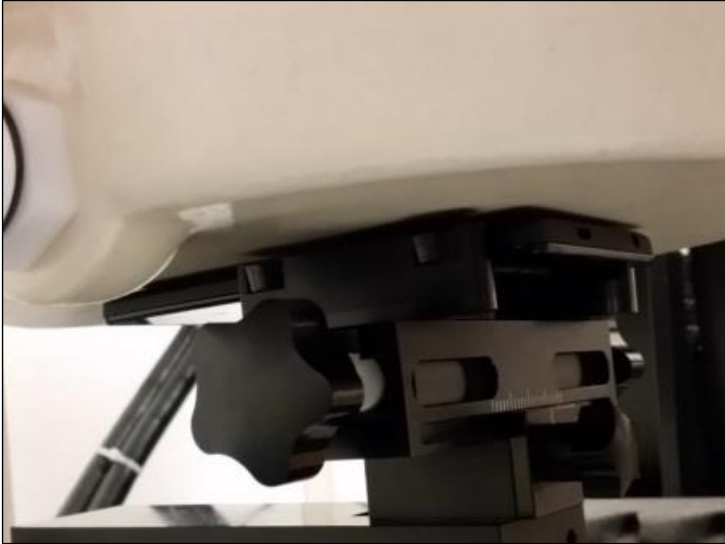
Photo 9: Position d'essai face arrière contre le corps (distance 0 mm)
