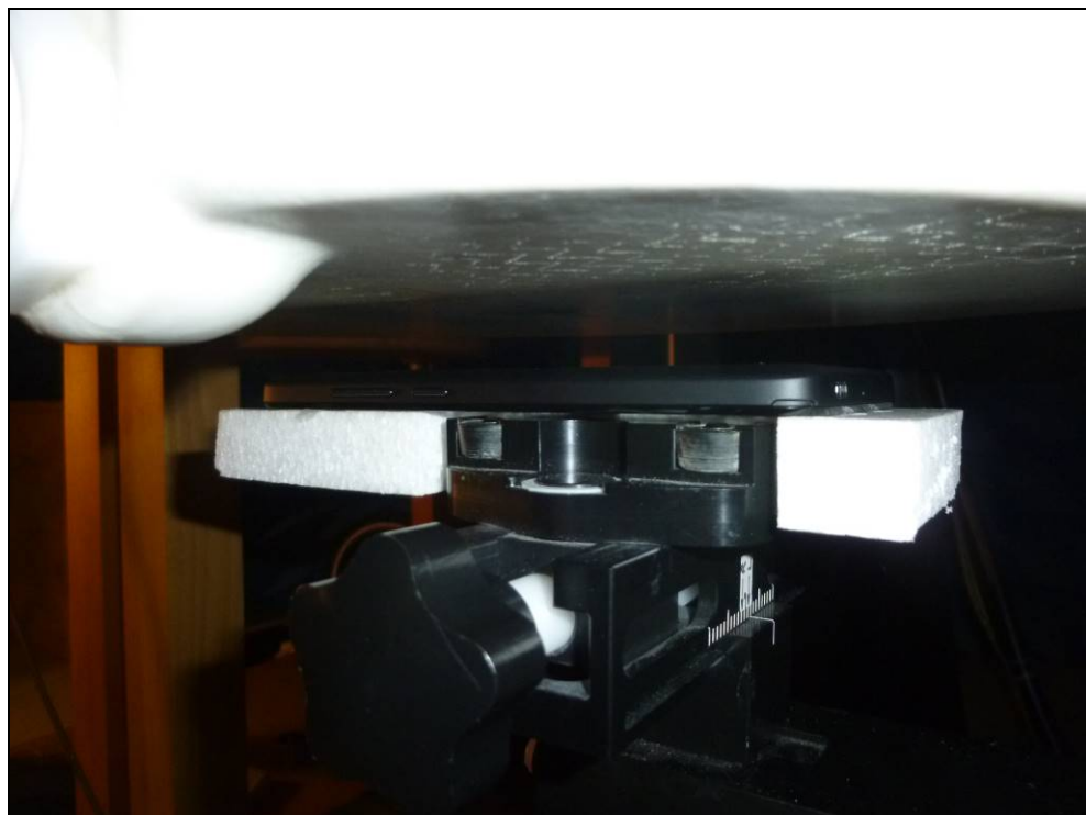
Fig. 16 : Face arrière à 1.5cm du fantôme SAM
