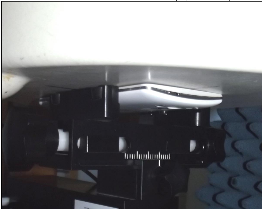
Photo 8: Position d'essai face avant contre le corps (distance 0 mm)
