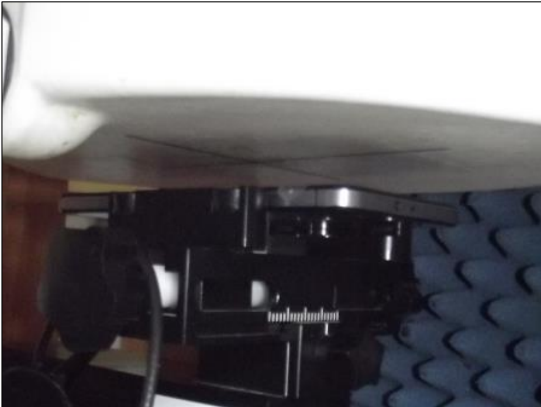
Photo 8: Position d'essai face avant contre le corps (distance 15 mm)
