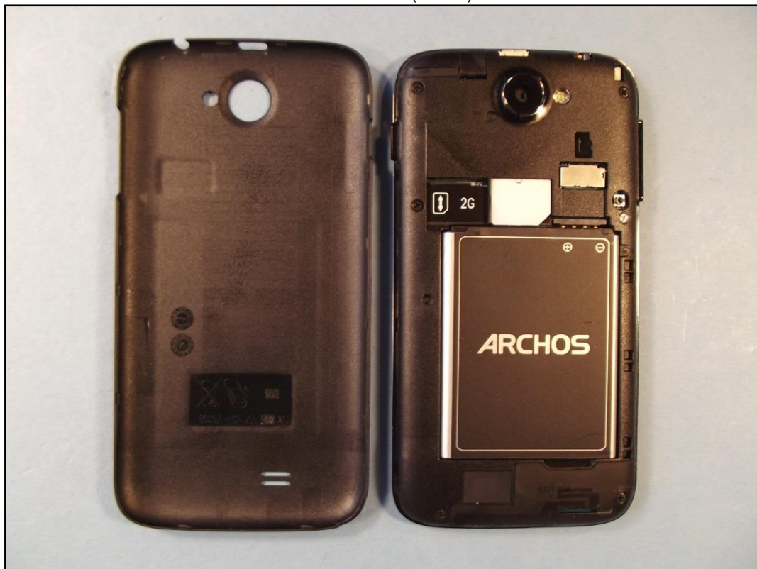
Photo 5: EST – vue arrière (ouvert) avec batterie
