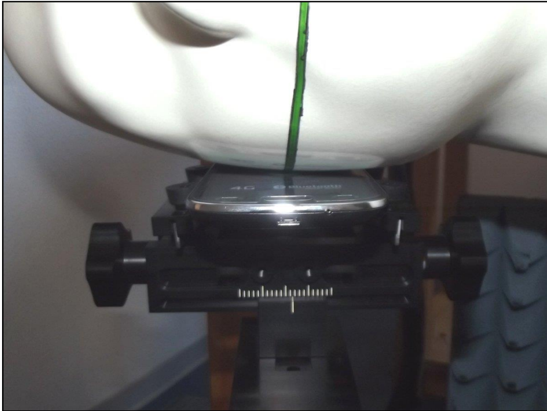
Photo 14: Position d'essai main droite, contre la joue
