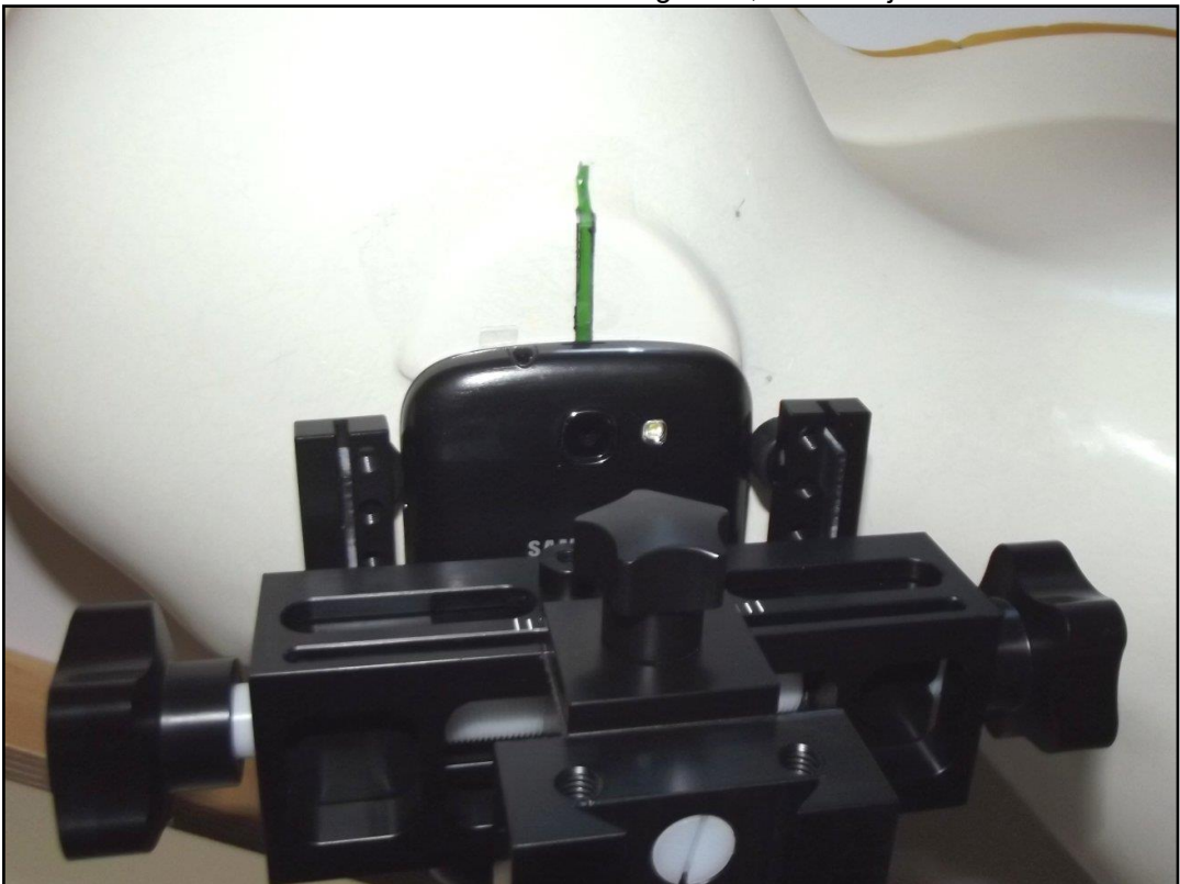
Photo 10: Position d'essai main gauche, contre la joue
