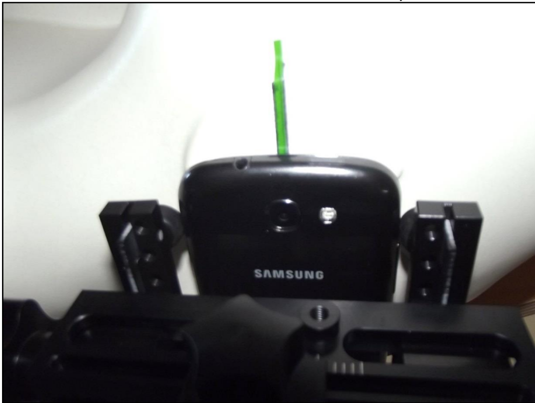
Photo 16: Position d'essai main droite, incliné 15°
