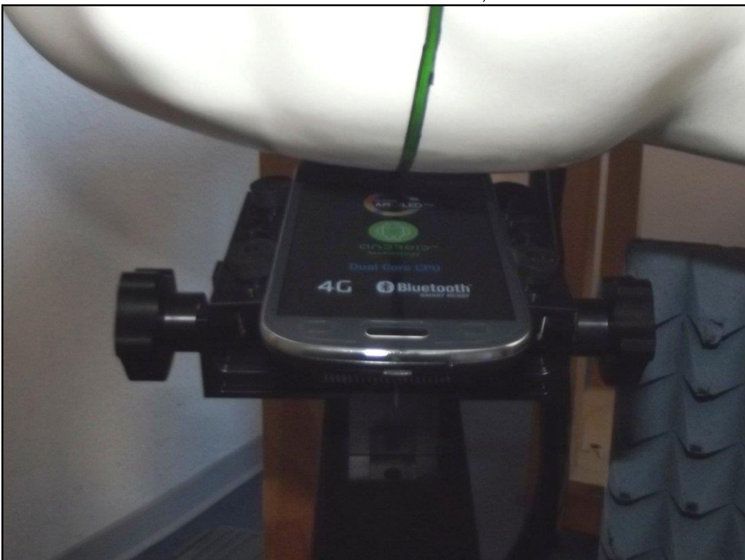
Photo 16: Position d'essai main droite, incliné 15°
