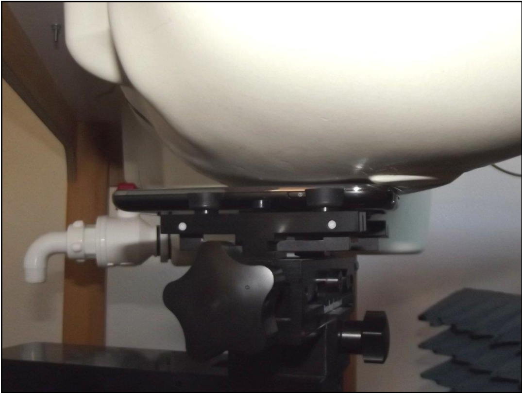
Photo 10: Position d'essai main gauche, contre la joue
