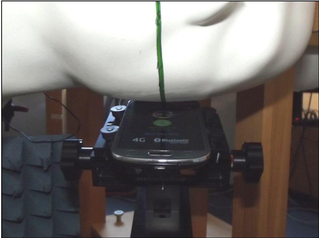
Photo 12: Position d'essai main gauche, incliné 15°
