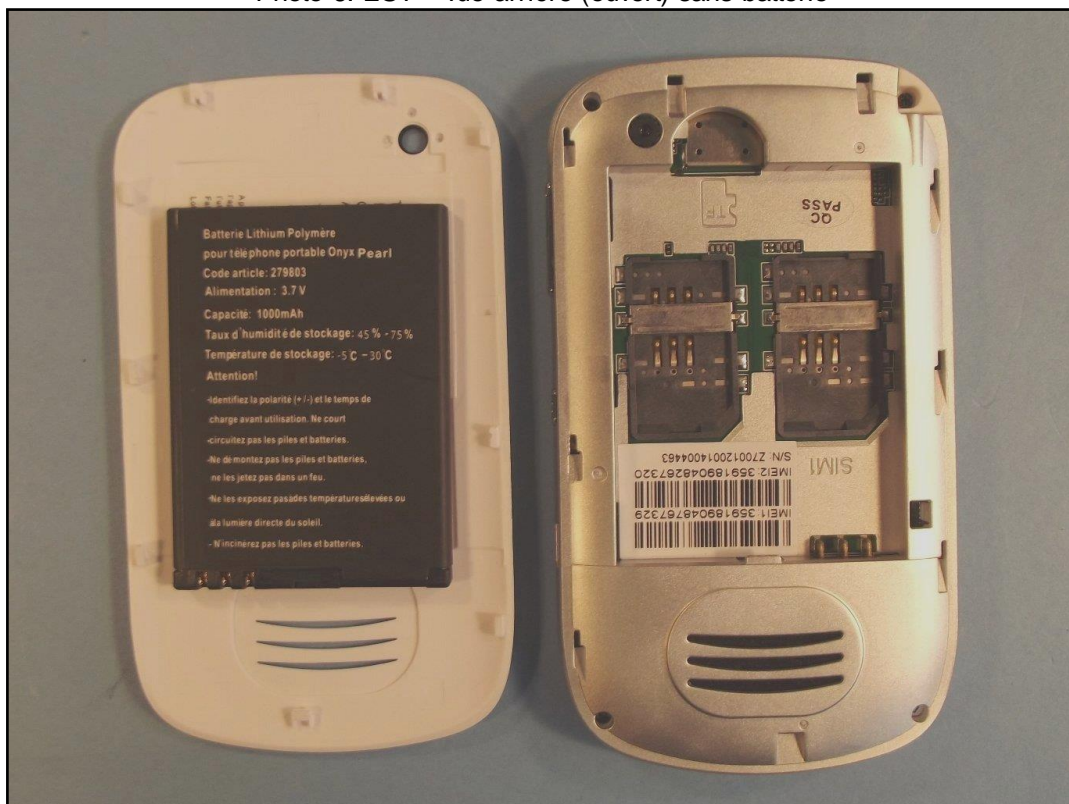
Photo 6: EST – vue arrière (ouvert) sans batterie
