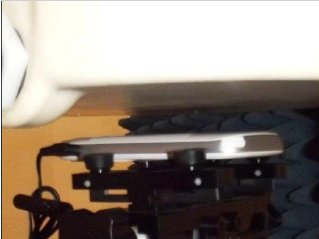
Photo 13: Position d'essai face arrière contre le corps (distance 0 mm)
