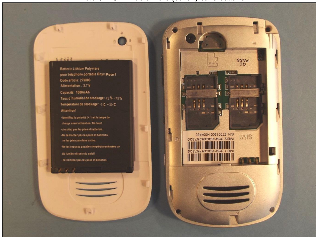
Photo 6: EST – vue arrière (ouvert) sans batterie
