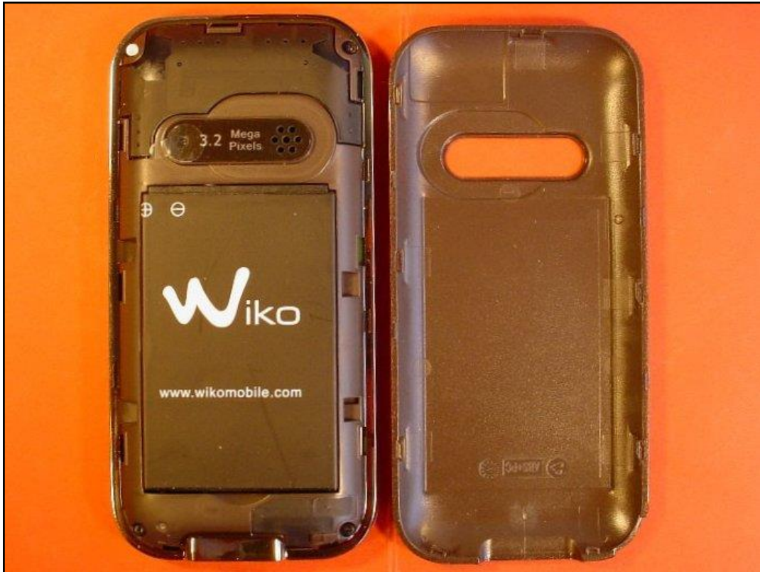
Photo 5: EST – vue arrière (ouvert) avec batterie
