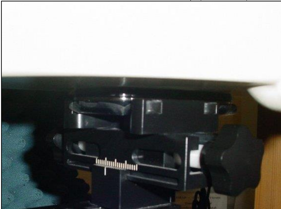
Photo 10: Position d'essai face avant contre le corps (distance 0 mm)
