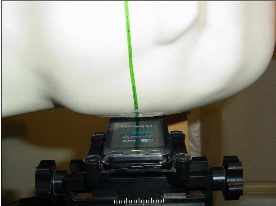
Photo 14: Position d'essai main gauche, incliné 15°
