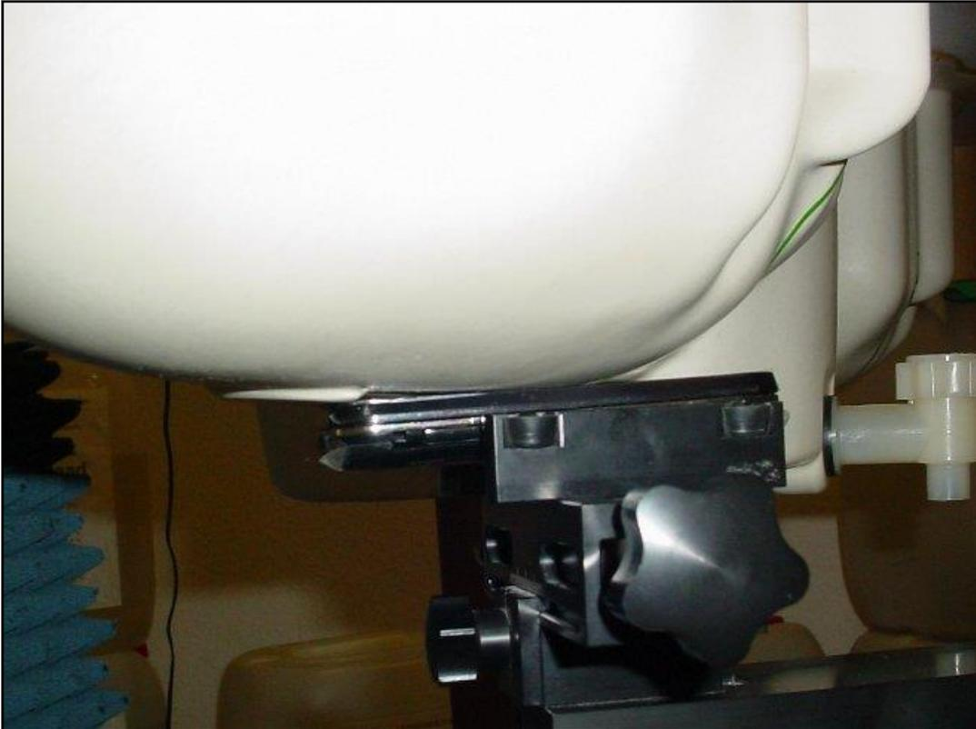
Photo 17: Position d'essai main droite, contre la joue
