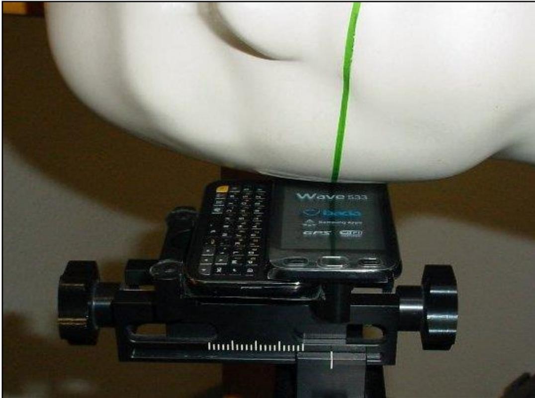
Photo 28: Position d'essai main droite, incliné 15° (glissière ouverte)
