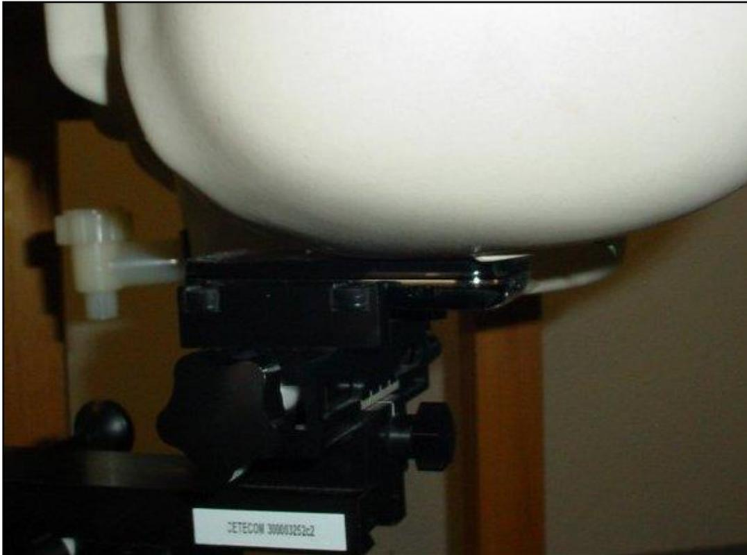
Photo 12: Position d'essai main gauche, contre la joue
