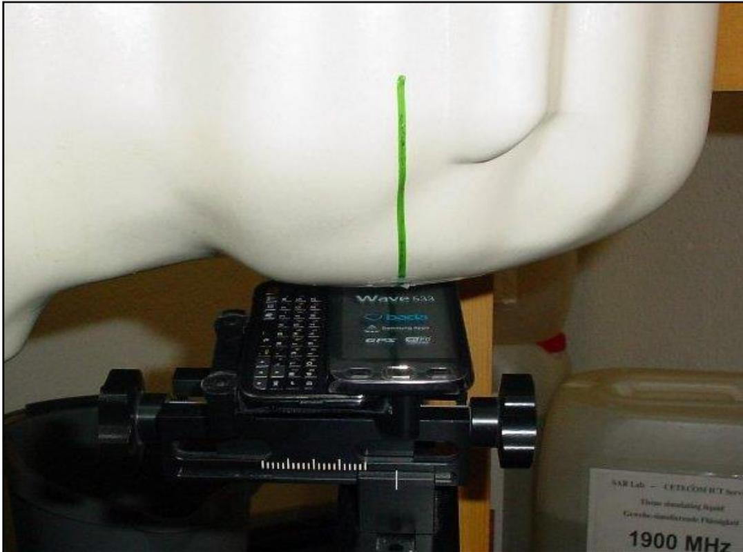
Photo 24: Position d'essai main gauche, incliné 15° (glissière ouverte)
