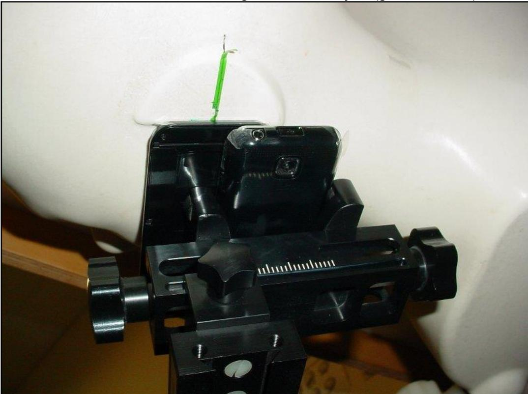
Photo 23: Position d'essai main gauche, incliné 15° (glissière ouverte)
