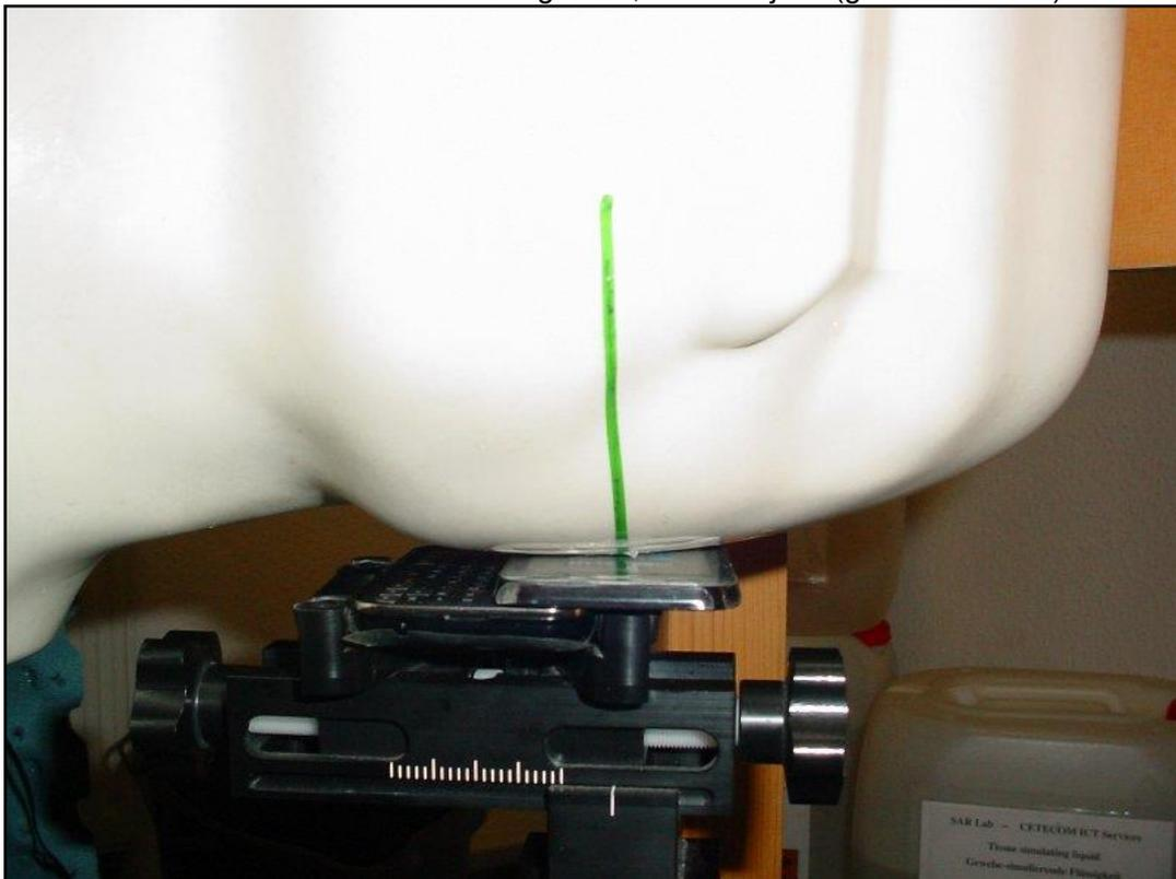
Photo 21: Position d'essai main gauche, contre la joue (glissière ouverte)
