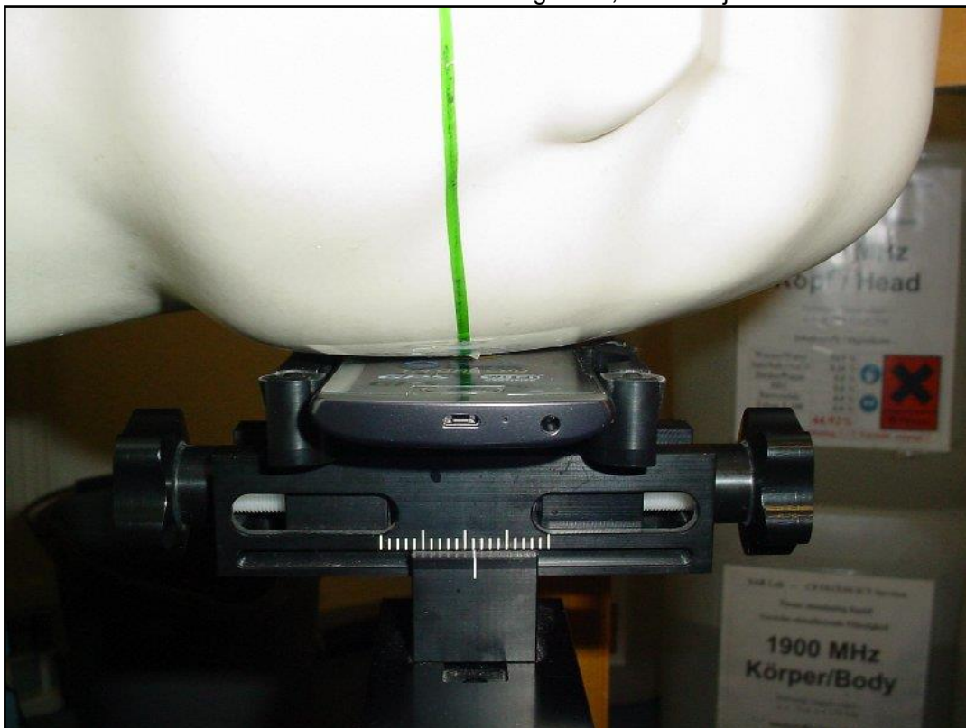
Photo 8: Position d'essai main gauche, contre la joue
