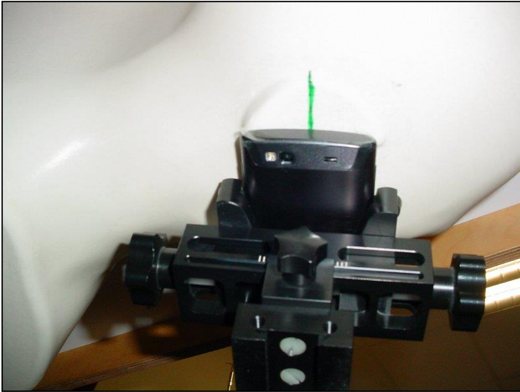
Photo 16: Position d'essai main droite, incliné 15°
