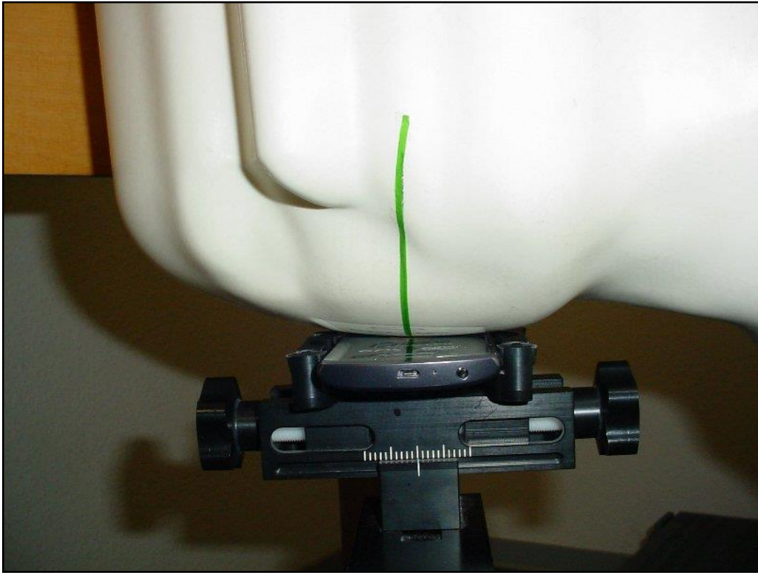
Photo 14: Position d'essai main droite, contre la joue
