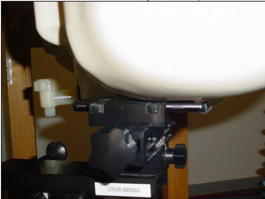
Photo 10: Position d'essai main gauche, contre la joue
