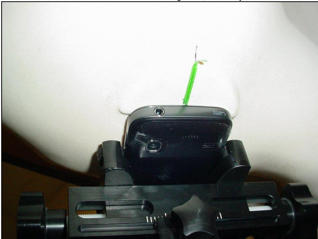
Photo 10: Position d'essai main gauche, contre la joue
