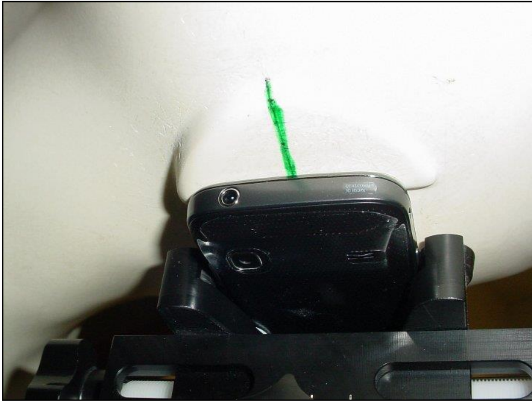
Photo 16: Position d'essai main droite, incliné 15°
