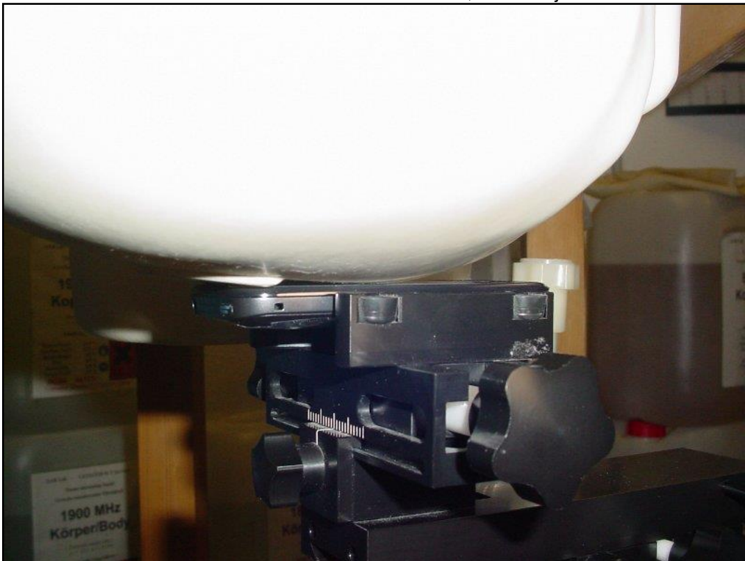
Photo 14: Position d'essai main droite, contre la joue
