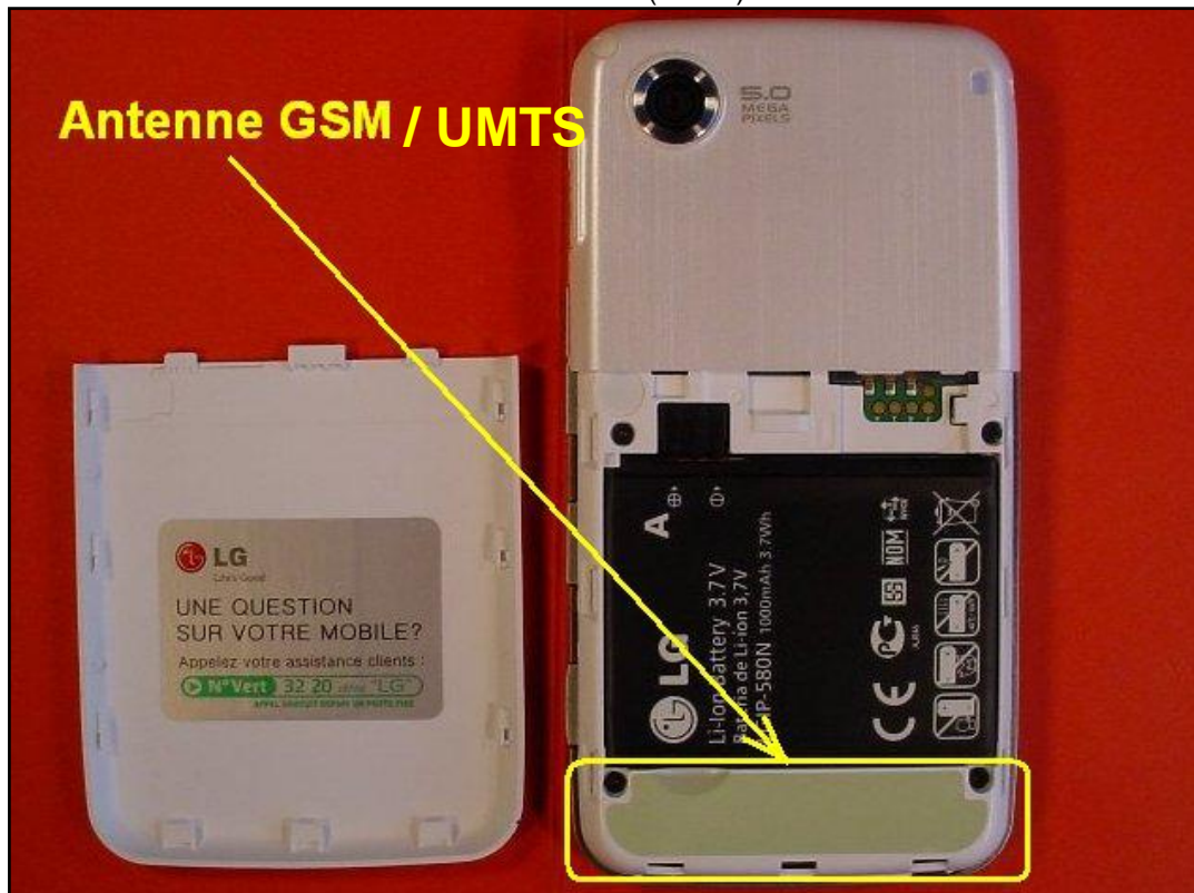
Photo 4: EST – vue arrière (ouvert) avec batterie
