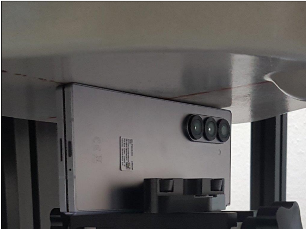
Photo 16: Position d'essai face du côté droite pilé contre le membre (distance 0 mm)
