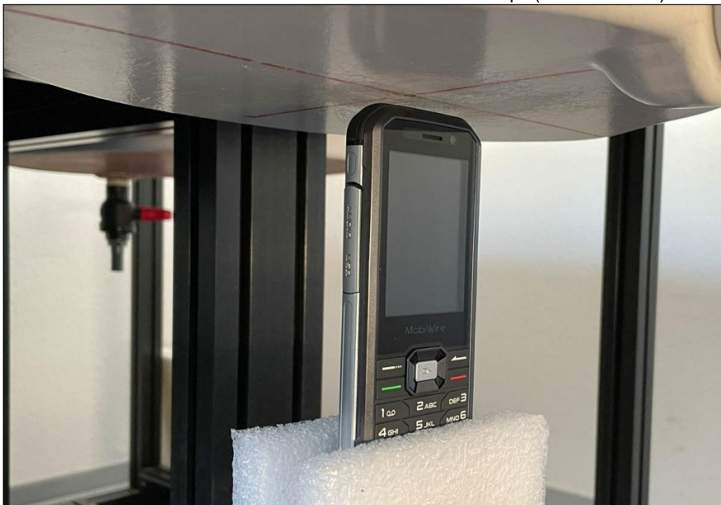
Photo 12: Position d'essai face du dessus contre le corps (distance 5 mm)
