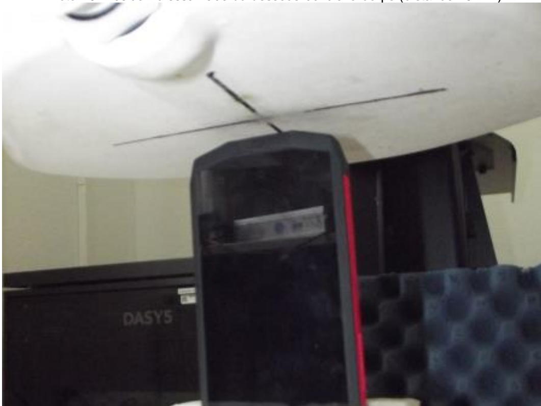
Photo 10: Position d'essai face du dessous contre le corps (distance 10 mm)
