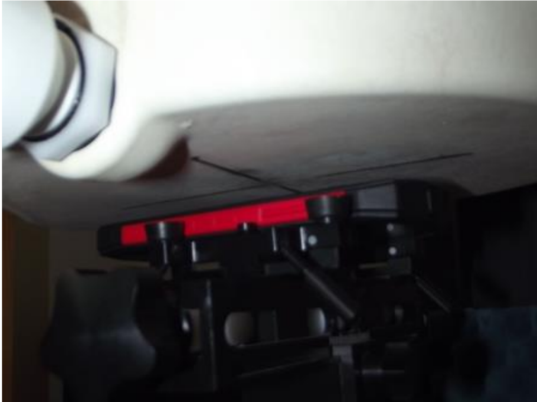
Photo 8: Position d'essai face du côté gauche contre le corps (distance 10 mm)
