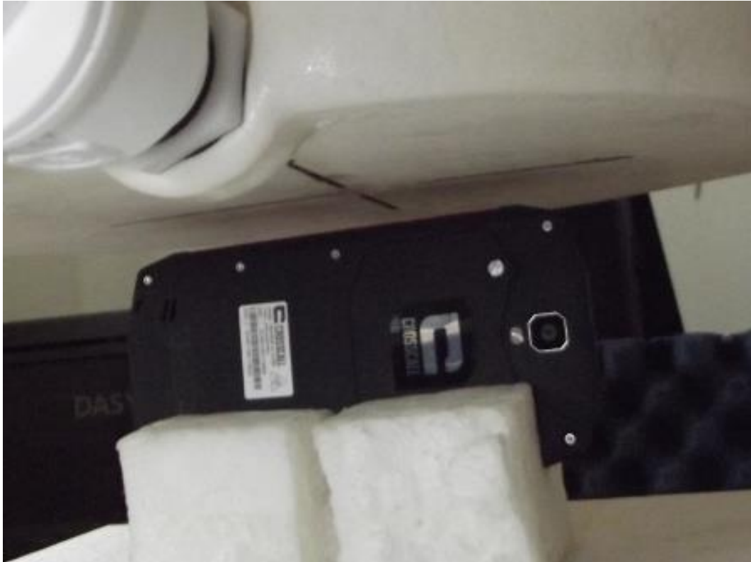
Photo 10: Position d'essai face du dessous contre le corps (distance 10 mm)
