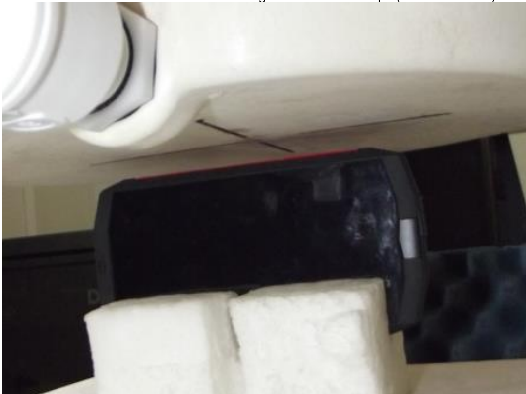
Photo 8: Position d'essai face du côté gauche contre le corps (distance 10 mm)
