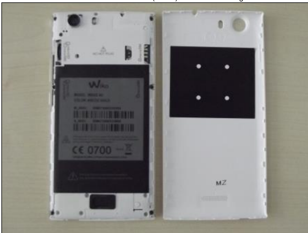
Photo 5: EST – vue arrière (ouvert) avec batterie intégrée
