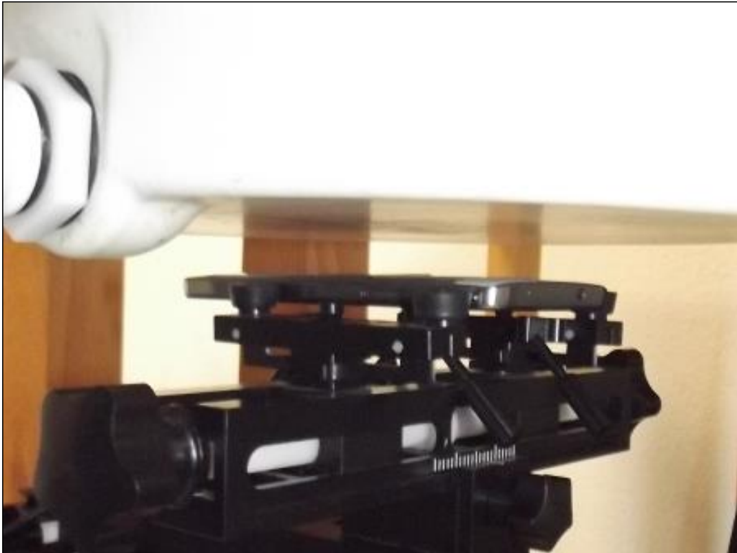
Photo 10: Position d'essai face arrière contre le corps (distance 10 mm)
