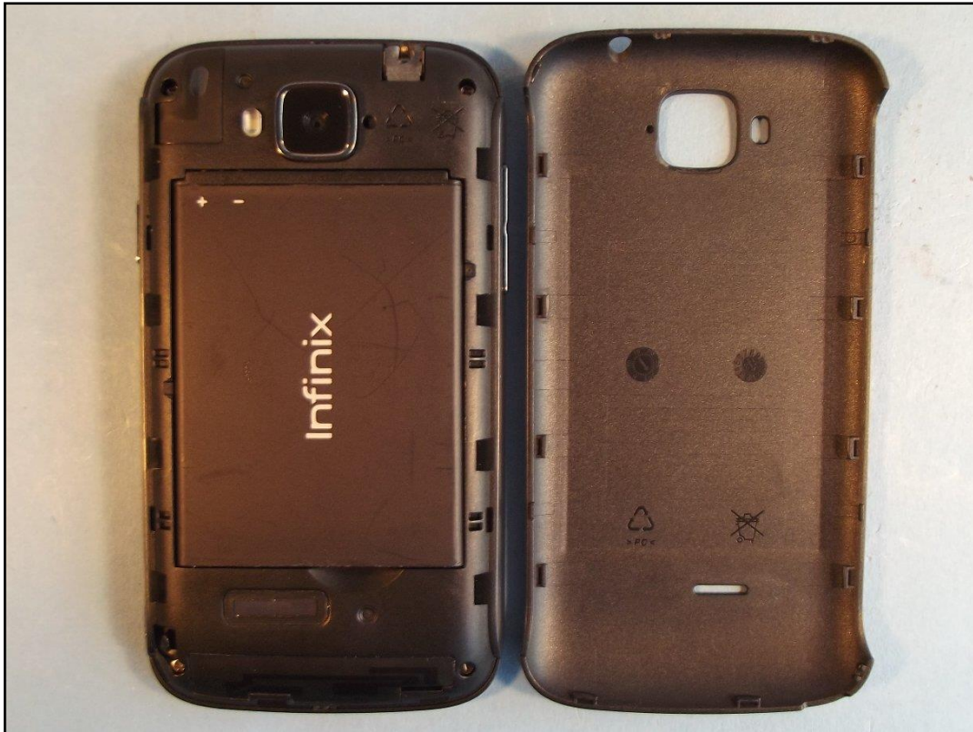
Photo 5: EST – vue arrière (ouvert) avec batterie
