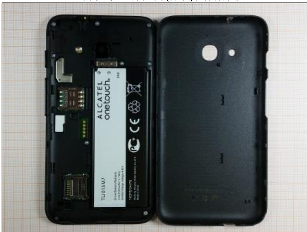
Photo 5: EST – vue arrière (ouvert) avec batterie
