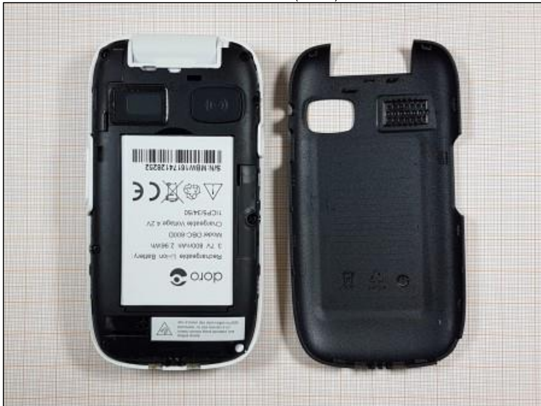
Photo 6: EST – vue arrière (ouvert) avec batterie
