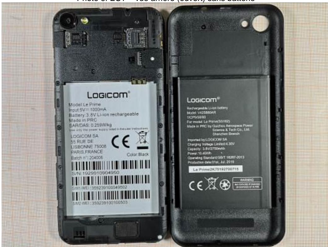
Photo 6: EST – vue arrière (ouvert) sans batterie
